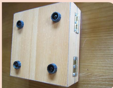
Il y a une connexion entre l'aiguille et un des pieds de support sous la boîte. Ce pied tourne simultanément avec la grande aiguille.
